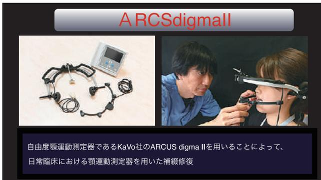
図11 アルクスディグマII (超音波デジタル顎機能運動装置, Kavo社)
